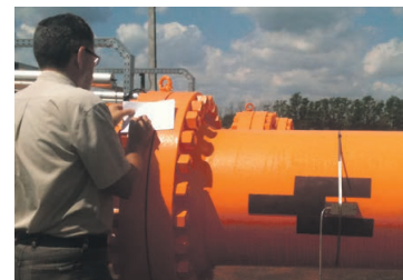
Die Ultraschall-Technologie funktioniert berührungslos.
