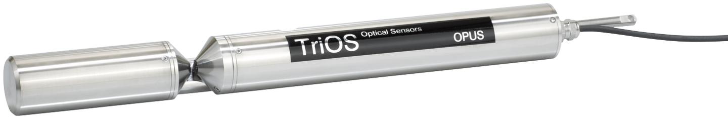
OPUS ist die neue Generation von Spektralsonden für die Online-Messung von Stickstoff- und Kohlenstoffverbindungen. Durch die Analyse eines vollständigen Spektrums ist OPUS in der Lage, verlässliche Messwerte für  $\text{NO}_3\text{-N}$ ,  $\text{NO}_2\text{-N}$ , organischen Inhaltsstoffen ( $\text{CSB}_{\text{eq}}$ ,  $\text{BSB}_{\text{eq}}$ ,  $\text{DOC}_{\text{eq}}$ ,  $\text{TOC}_{\text{eq}}$ ) und einer Reihe weiterer Parameter zu liefern.
