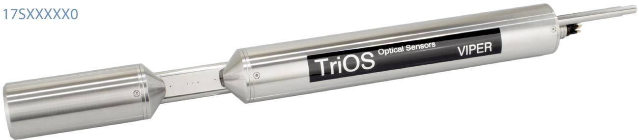
VIPER misst spektral aufgelöste Attenuation im Wellenlängenbereich zwischen 360 nm und 720 nm und erlaubt somit die detaillierte Bestimmung mehrerer Parameter zur gleichen Zeit. Als Lichtquelle dienen 5 ausgewählte und energiesparende LEDs, die stabile Messdaten und eine lange Lebensdauer gewährleisten. VIPER ist in verschiedensten Medien einsetzbar, da es in mehreren Pfadlängen und sowohl in Edelstahl als auch in Titan erhältlich ist. Anwendungsgebiete
