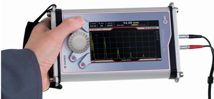
Das SONOWALL 70 verfügt über folgende Basisfunktionen für die Fehlerprüfung:
