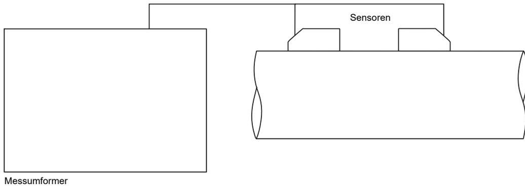
Beispiel für eine Wärmestrommessung mit Messung des Volumenstroms im Rücklauf
